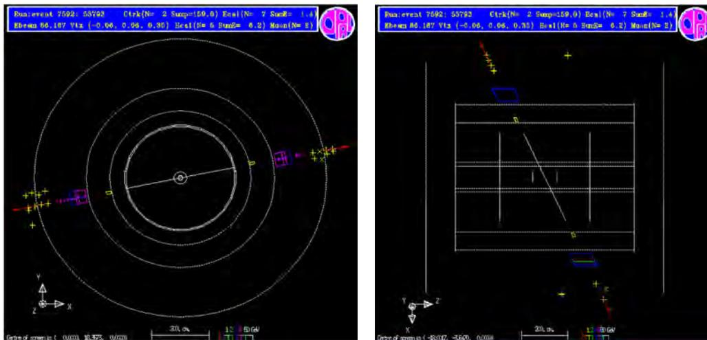
Figura 2. Display che mostra il decadimento di un bosone  $Z^0$  nell'esperimento OPAL, presso l'acceleratore LEP del CERN, in una coppia elettrone-positrone, nella sezione perpendicolare all'asse dei fasci (a sinistra) e parallela all'asse dei fasci (a destra).
