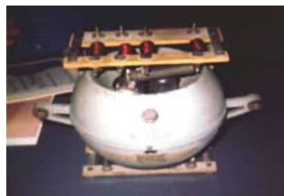
Figura 1b. Il risonatore a cavità rientrante (pentola)
