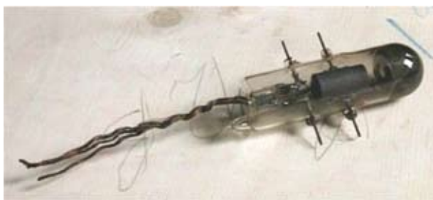
Figura 1a. Il triodo FIVRE 1628
