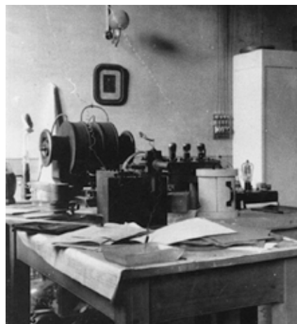
Figura 2b. Elettromagnete trocoidale
