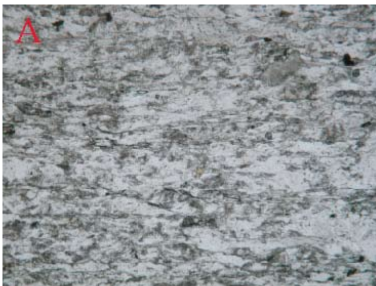
Figura 1a. Immagine al microscopio ottico a luce trasmessa (solo polarizzatore) di una sezione sottile (spessore ca. 30 micron) di un campione di Pietra del Cardoso; il campione è costituito principalmente da granuli di quarzo (cristalli bianchi) di circa 50 micron.
