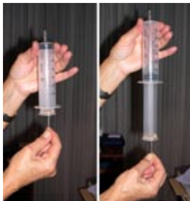
Figura 1. Per estrarre uno stantuffo da una siringa sigillata alla cima occorre applicare una forza almeno eguale alla pressione atmosferica moltiplicata per l'area della sezione del cilindro (nelle condizioni della fotografia, circa 6 kg).
